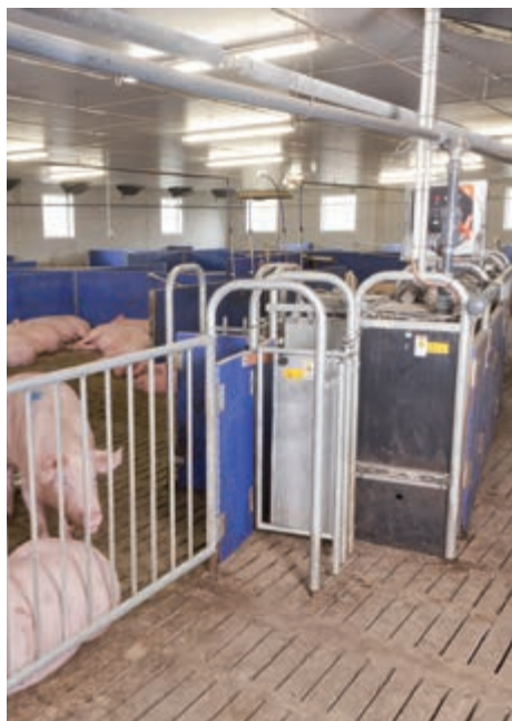
Станция кормления по вызову CallMatic pro в сочетании с HydroMix pro
