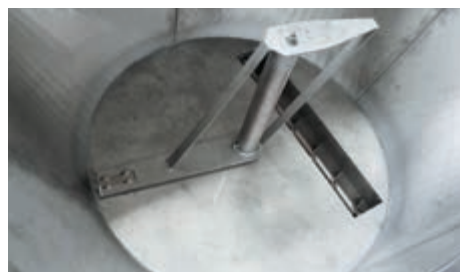
Дно емкости с Z-образной взвешивающей крестовиной и подающим шнеком
